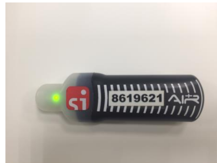
Рис.1 Световой индикатор, при успешной отметке (активации) в станции «ПРОВЕРКА»
