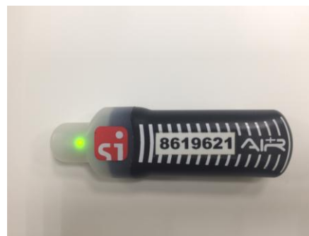
Рис.2 Мигающий зеленый световой индикатор, говорит о том, что ЧИП находится в активированном состоянии и готов к работе.
