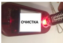
Рис.1 Световой индикатор, при успешной отметке ЧИПа SIAC в контактной станции «ОЧИСТКА»
