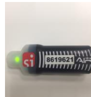
Рис.3 Периодически мигающий зеленый световой индикатор; говорит о том, что чип SIAC находится в активированном состоянии и готов к работе.
