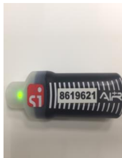
Рис.3 Периодически мигающий зеленый световой индикатор, говорит о том, что ЧИП SIAC находится в активированном состоянии и готов к работе.
